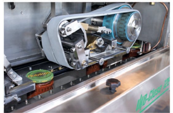
Укупорочный механизм с ремнями/ Belt closing mechanism
