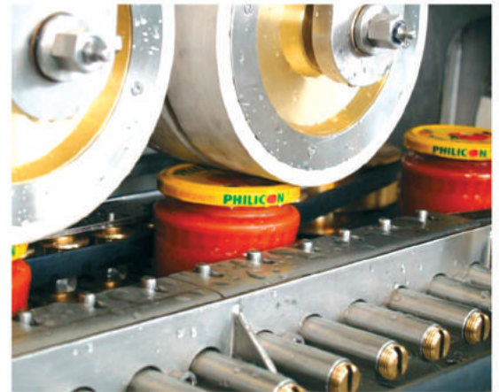
Укупорочный механизм с дисками/ Disc closing mechanism
