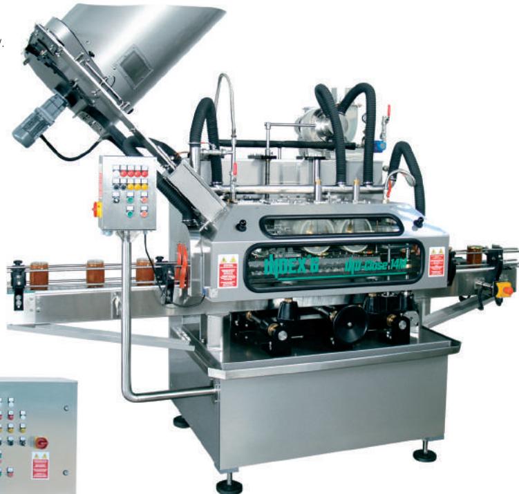
Укупорочный механизм с ремнями/ Belt closing mechanism
